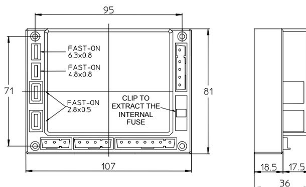
Рис. 1 – Габаритные размеры
