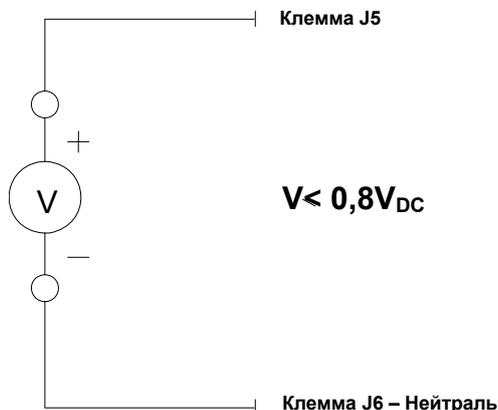
Рис. 8 – Измерение сигнала пламени в ж/т установках.
